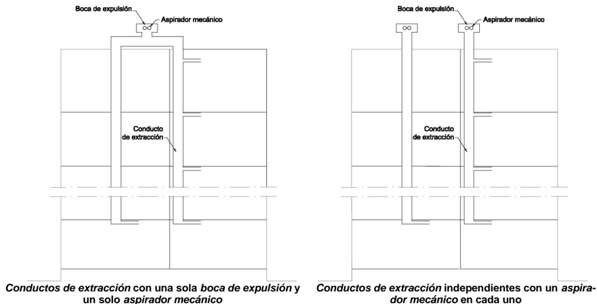
Figura 3.4 Ejemplos de disposición de aspiradores mecánicos
