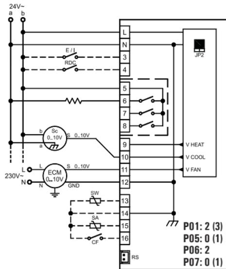
**Fig. 11:** Schema di collegamento per pilotaggio di un attuatore 0..10V a 24V ~ per impianto con resistenza di integrazione e pilotaggio proporzionale del ventilatore.
