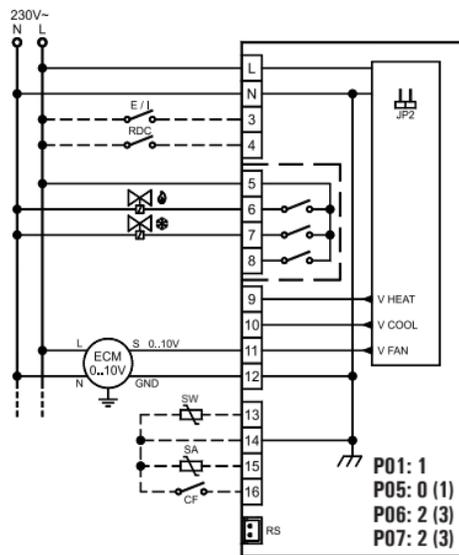
Nel caso di impianto a 2 tubi con un solo attuatore on/off, esso dovrà essere collegato sul morsetto 6.
