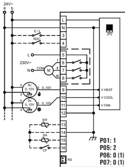
**Fig. 10:** Schema di collegamento per pilotaggio di due attuatori 0..10V a 24V ~ per impianto a 4 tubi e pilotaggio di un motore a tre velocità a 230V.
