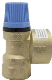
Válvula de seguridad de membrana. Cuenta con cuerpo en latón CW617N, pomo de descarga manual en tecnopolímero, muelle en acero al Ni-Cr, membrana y junta en caucho resistente hasta 110°C.
