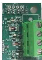
Regleta de conexionado de 2 velocidades en la PCB
