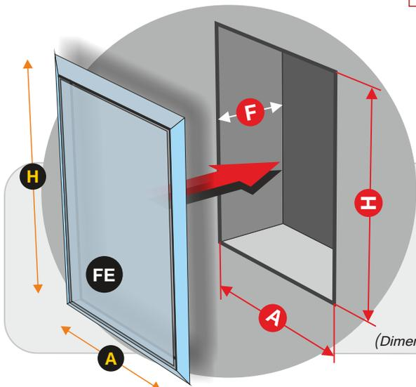
DIMENSIONES DEL HUECO PARA INSTALACIÓN EMPOTRAMIENTO
