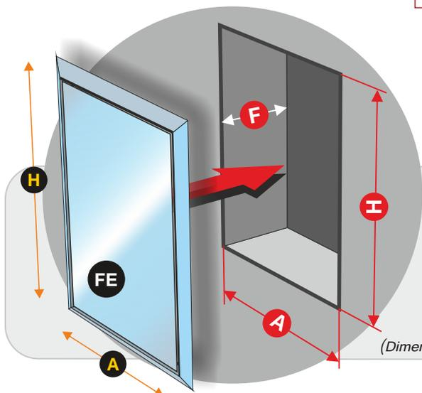
DIMENSIONES DEL HUECO PARA INSTALACIÓN EMPOTRAMIENTO
