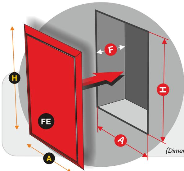
DIMENSIONES DEL HUECO PARA INSTALACIÓN EMPOTRAMIENTO
