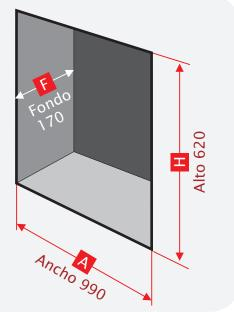
DIMENSIONES DEL HUECO PARA INSTALACIÓN EMPOTRAMIENTO
