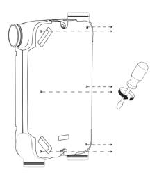
4 Retirar la tapa exterior y el polipropileno frontal de la Unidad, dejando el interior al descubierto
