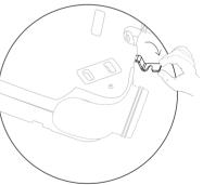
1.3 Atornillar los Ganchos Silentblock en la nueva posición deseada.
