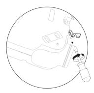
2 Perforar la superficie marcada y atornillar los soportes de fijación a través de los orificios ovalados.
