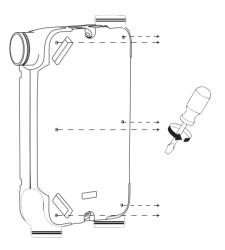
3 Retirar la tapa exterior y el polipropileno frontal de la Unidad, dejando el interior al descubierto
