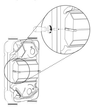
6 Separar las lenguetas de sujeción para sacar el intercambiador
