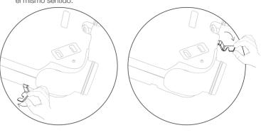
1.3 Atornillar los Ganchos Silentblock en la nueva posición deseada.
