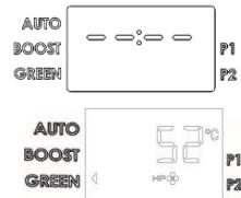
**Wyłączenie:** aby wyłączyć urządzenie należy nacisnąć przycisk ON/OFF, pozostaje jedynie widoczny komunikat "OFF" na wyświetlaczu. W tym trybie działa zabezpieczenie antykorozjowe zasobnika oraz zabezpieczenie przeciw zamrożeniowe, które nie pozwala na spadek temperatury poniżej 5°C.
