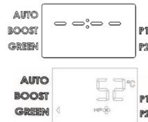
**Apagado:** para apagar el calentador de agua es suficiente presionar el botón ON/OFF, y permanece sólo la sigla "OFF" en el visor. La protección contra la corrosión sigue estando asegurada y el producto se encargará automáticamente de no permitir el descenso la temperatura del agua en el depósito por debajo de los 5°C.
