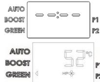
**Apagamento:** para apagar o esquentador, basta premir a tecla ON/OFF, permanecendo apenas a indicação "OFF" no visor. A protecção contra a corrosão continua a ser assegurada e o produto manterá automaticamente a temperatura da água do depósito acima dos 5°C.
