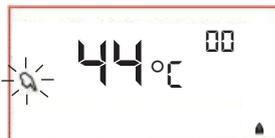
Desde ese momento la caldera empieza a funcionar en calefacción a la máxima potencia, con apagado a 80°C y nuevo encendido a 70°C.
