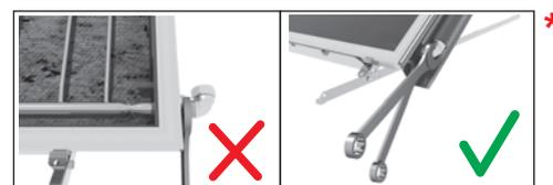
10. Coloque y apriete el tapón roscado mecánicamente Ø22 en la parte superior derecha y en la parte inferior izquierda del colector/colectores\*. Coloque el depósito de almacenamiento de agua en la base con sus componentes eléctricos a la izquierda, mirando el depósito de almacenamiento de agua por delante.
