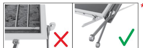
15. Coloque y apriete el tapón roscado mecánicamente  $\varnothing 22$  en la parte superior derecha y en la parte inferior izquierda del colector/colectores\*. Coloque el depósito de almacenamiento de agua en la base con sus componentes eléctricos a la izquierda, mirando el depósito de almacenamiento de agua por delante.
