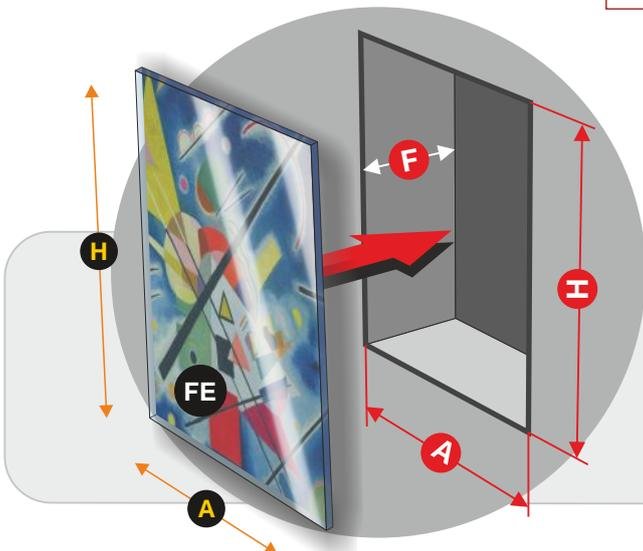
**DIMENSIONES DEL HUECO PARA INSTALACIÓN EMPOTRAMIENTO**
