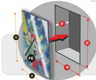
DIMENSIONES DEL HUECO PARA INSTALACIÓN EMPOTRAMIENTO
