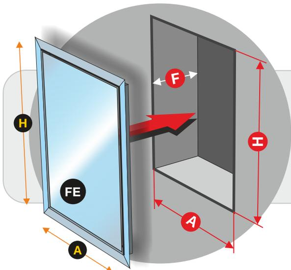
DIMENSIONES DEL HUECO PARA INSTALACIÓN EMPOTRAMIENTO
