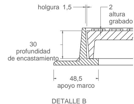
Material: Fundicion ductil GGG40
