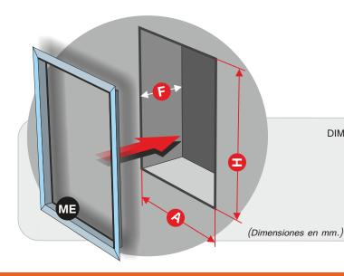
DIMENSIONES DEL HUECO PARA INSTALACIÓN EMPOTRAMIENTO
