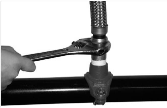
2. Antes de la instalación, compruebe que el sellado dentro de la tuerca de la manguera flexible esté en su sitio y que no esté dañado. Conecte la tuerca a la boquilla adaptadora según se indica.
