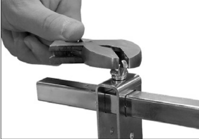
**PARA SOPORTES AJUSTABLES (DISPONIBILIDAD REGIONAL ÚNICAMENTE):** Para ajustar, afloje el tornillo de mariposa de la parte superior de un soporte final para poder deslizar el soporte por la barra cuadrada. Apriete el tornillo de mariposa a cada lado del soporte final a un par de 36 pulg.-lbs/4 N•m (entre ½ y ¾ de vuelta más que el apriete a mano) para fijar los soportes a la barra cuadrada.
