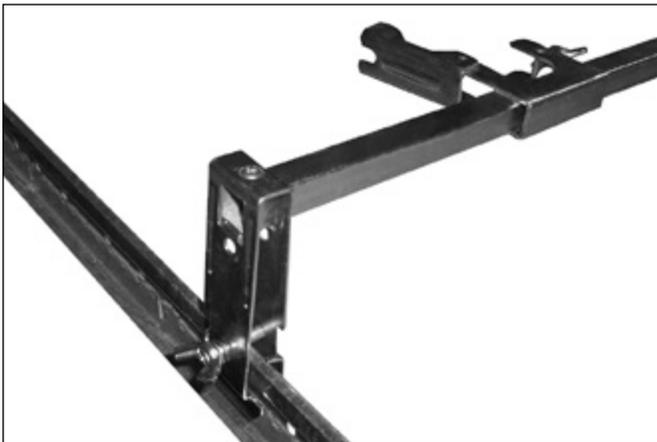
1. Conecte los soportes finales del soporte Estilo AB7 a los raíles de la barra en T de un sistema de suspensión de techo ASTM C635 instalado conforme a la norma ASTM C636. Compruebe que los extremos del soporte Estilo AB7 se inserten en los raíles.
