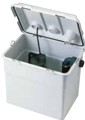
Estaciones automáticas de recogida y evacuación de aguas domésticas procedentes de bañeras, lavabos, duchas y lavadoras situadas en sótanos o por debajo del nivel de la red de alcantarillado. Equipadas con una electrobomba NOVA 300 con 5 metros de cable de alimentación y enchufe, instalada en un depósito de tecnopolímero con una capacidad de 30 litros y una válvula antirretorno instalada en la impulsión. La estación de elevación se entrega completa y lista para su uso.
