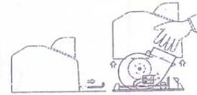
1.c) Fixer la base au mur, après le forage avec 4 trous de Ø 8, en utilisant le modèle en papier foumi, à visser avec les vis fournies dans le sac de quincaillerie.
