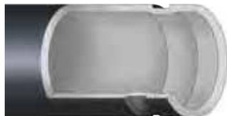
Ranura por laminación en un tubo de acero Schedule 40. La pequeña protuberancia creada en la pared interior del tubo no afecta significativamente a la presión ni al flujo.
